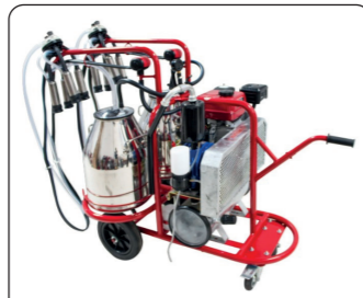
De correa con bomba de 350 Lt, 1 motor, 2 puestos, 2 tanques de 30 Lt (Opcional motor eléctrico)
